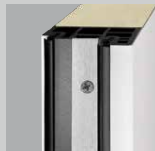
A 65 mm vastag ajtólapalappal rendelkező MZ Thermo65 többcélú ajtó különösen jó, akár 0,87 \text{ W/(m}^2\cdot\text{K)} U_D -értékével elsőosztályú hőszigetelést nyújt.
