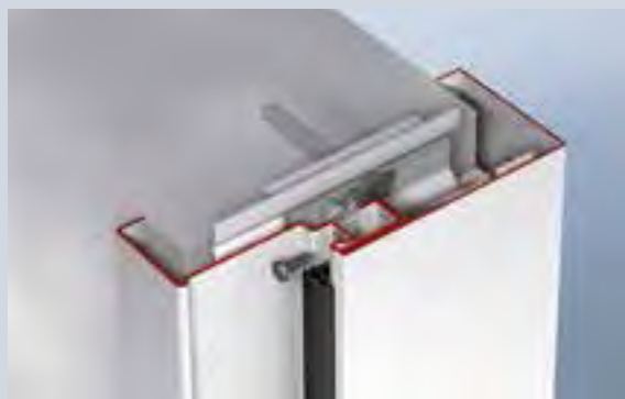
Csavarozza a 2. (ellen-)tokprofil a tömítési hornyon keresztül az 1. tokprofilhoz, majd takarja el azt az ajtó-tömítéssel
